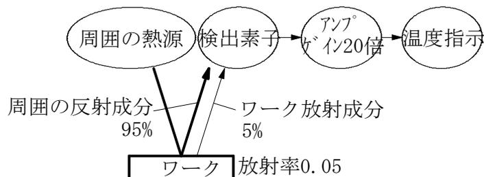
このためワークからの放射エネルギーよりも、周囲にある物体(壁、温度計等)からの放射エネルギーがワーク表面で反射して温度計に入射される成分の方が大きくなります。温度計は内部アンプのゲインを 20 倍にして温度表示をすることになり、結果的に温度計の誤差、安定性等および周囲にある物体の温度変動の影響が 20 倍に拡大されて表示されます。TMHX-CM シリーズはこれらの問題に対処するように設計されていますが、使用する際も従来の放射温度計よりも各種の注意、制限事項があり、今までに経験したことのない別世界です。
