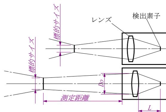
ファイバ形温度計で LED 照準またはレーザ照準の場合は、単純な屈折レンズを使用するとレンズの色収差により赤外線のピント位置と可視光のピント位置にずれが生じてしまいます。この場合、色収差補正レンズまたは反射レンズを使用します。光学照準の場合は、レンズとファイバ端面間および接眼鏡筒の位置をずらせることができるため、単純な屈折レンズでも問題ありません。
