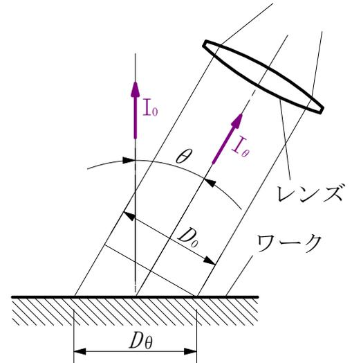
垂直軸からの角度による標的サイズの変化(光路が平行の場合)
