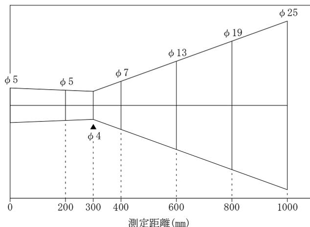
図に表示されていない中間の測定距離の時の標的サイズは、その部分の台形の辺の寸法から比例計算で求めます。
