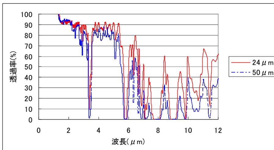
プラスチックは材質によって吸収波長が異なります。主な材質の吸収波長をつぎに示します。
