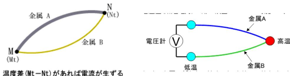
熱起電力を利用するための2種の金属の組合せを熱電対といいます。熱電対の熱起電力は、その熱電対を構成している2種の金属の種類および両接点の温度によります。熱電対温度計は、熱起電力を測ることによって温度を測定するものです。
