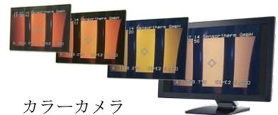
カラーカメラモジュール付きの放射温度計はビデオモニターまたはコンバーター付きのPCに接続できる複合ビデオ出力を提供します。放射温度計は、テレビ画面上の円形のレチクルを介して位置合わせされており、熱く輝くターゲットの遠隔観測や照準管の観察に推奨されます。このカメラは、画像の明るさを自動的に高度に動的に調整します。
