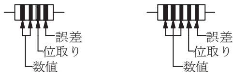
4本線式(誤差2%以上の抵抗) 5本線式(誤差1%以下の抵抗)
